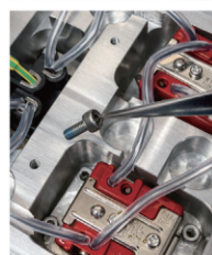
（画像左） 航空機アルミ合金製 SRリジッドマウント
